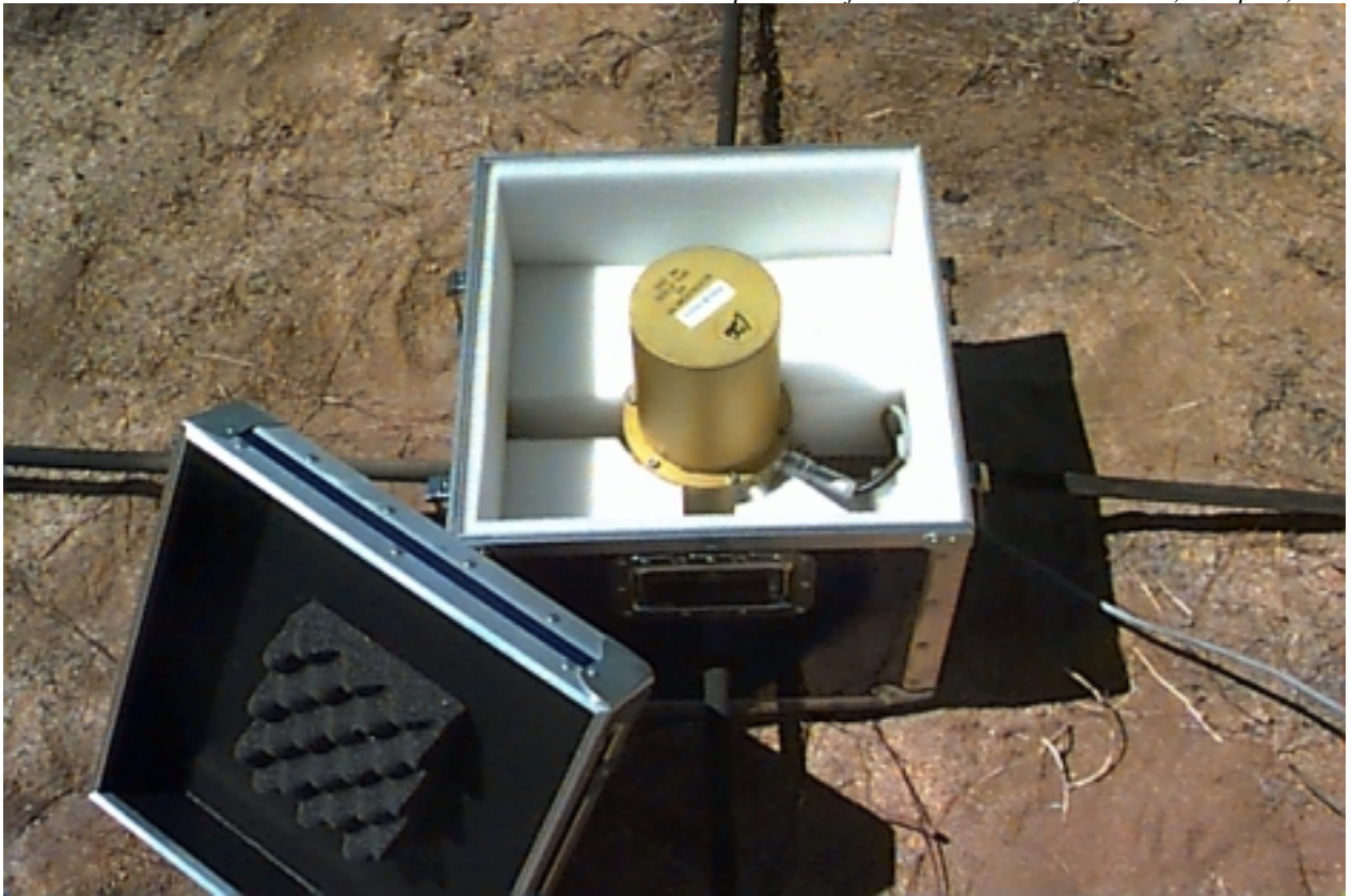
Figure C.2. An MB2000 inside the mini vault.
